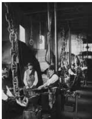
Kovárna pro výrobu kotevních řetězů 1878
